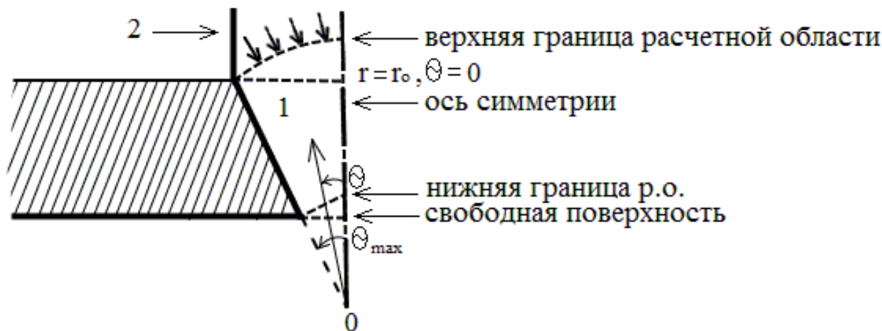
Рис. 1. Схема течения металла в конической матрице.
