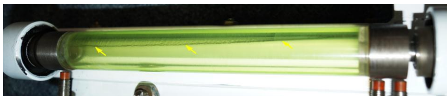
Рис.4. Вынужденное волновое движение с почти прямым фронтом внутри длинного ротора
