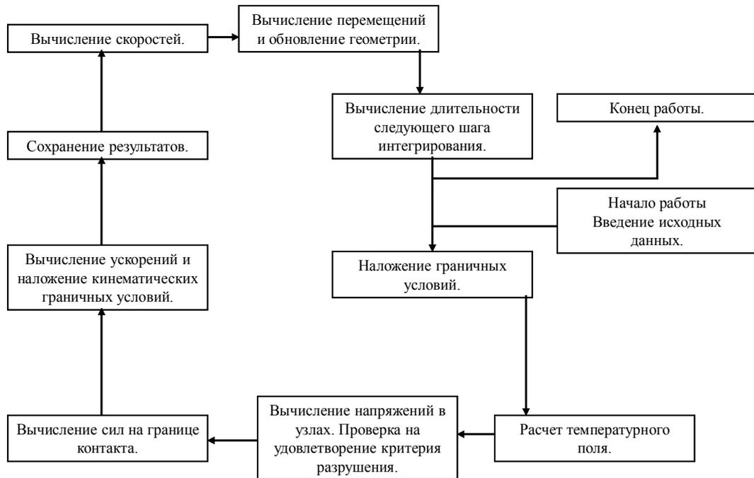
Рис.1. Общий алгоритм решения взаимосвязанной термомеханической задачи.
