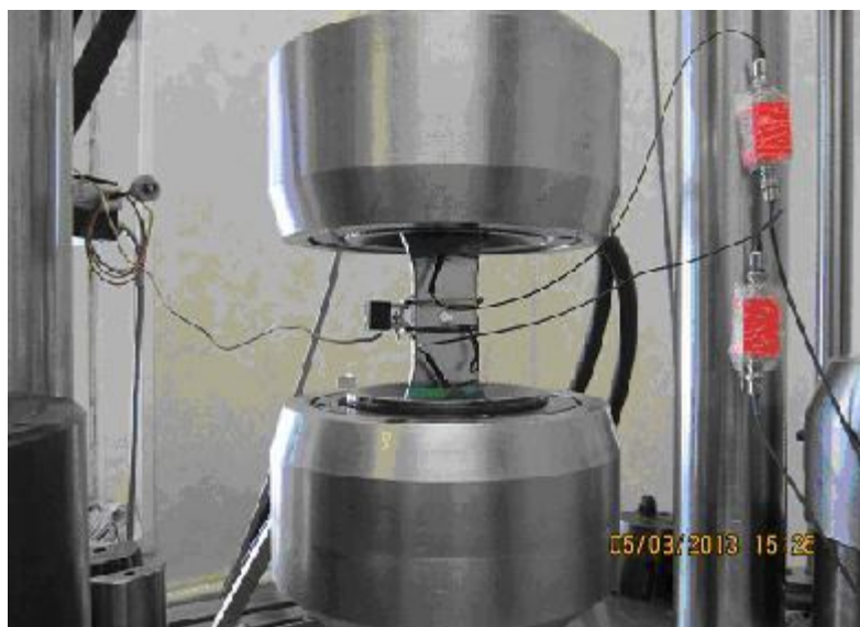
Рис. 2. Исследование ранних повреждений в образцах композитных материалов на основе совместного использования тензоиндикаторов (хрупких покрытий) и акустико-эмиссионной системы
