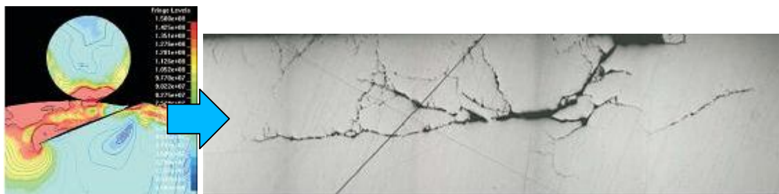
Рис. 5. Конечно-элементное моделирование микроповреждений поверхностных слоев и бифуркации микротрещины.
