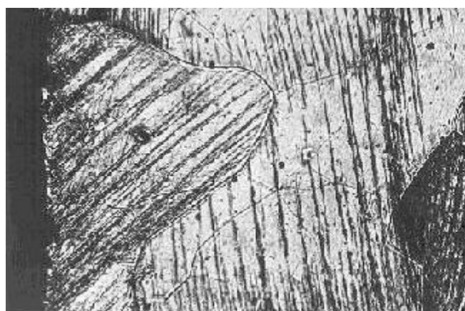
Рис.5. Развитие полос скольжения в зоне разрушения образцов технического железа, испытанного при 200 0 С: а) – х 200; б) – х 500.
