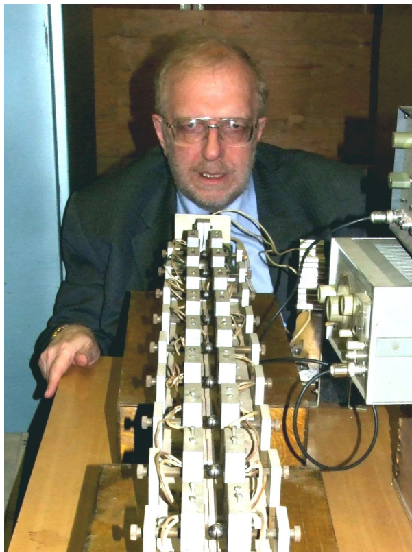
Рис. 3. Стенд «Аллигатор» для исследования виброударных процессов в системах со многими ударными парами
