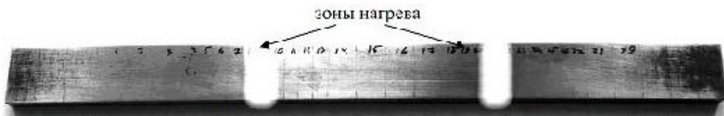
Рис. 7. Схема локального термического воздействия на образец из стали СтЗсп.
