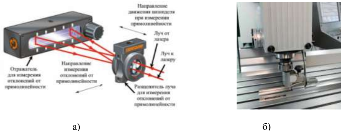
Рис. 6. Перспективные средства измерения отклонений от прямолинейности: а) набор оптики и схема направления лучей лазера при измерении отклонений от прямолинейности движения расщепителя, установленного в шпинделе, б) общий вид штриховой линейки мод. VM 182, установленной на столе станка.
