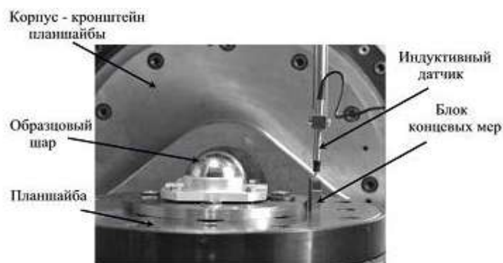
Рис. 11. Общий вид приспособления для измерения \Delta_{bcx} и \Delta_{bcz} при горизонтальном положении планшайбы.
