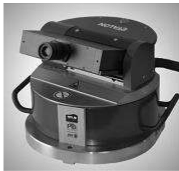
Рис. 12. Лазерный интерферометр мод. XD Laser: а) общий вид интерферометра, б) индикация измеряемых отклонений в процессе измерения, в) схема измерения отклонений.
