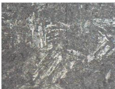
Рис. 2 – Микроструктура материала пера рабочей лопатки 5 ступени осевого компрессора ГТК-10И (x 500).
