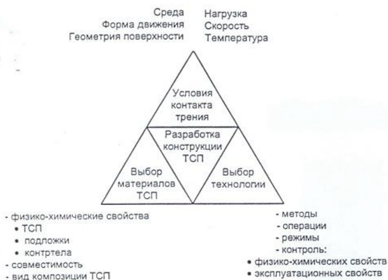
Рис. 1. Взаимодействие основных этапов разработки конструкции ТСП
