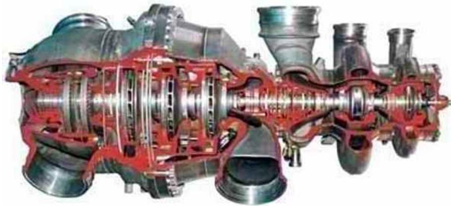
Рис.1. Пример турбонасосного агрегата последнего поколения [1]
