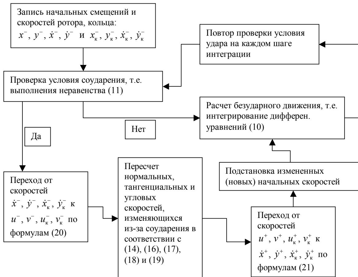
Рис.4. Принципиальная блок-схема расчета виброударной системы “ротор-кольцо”
