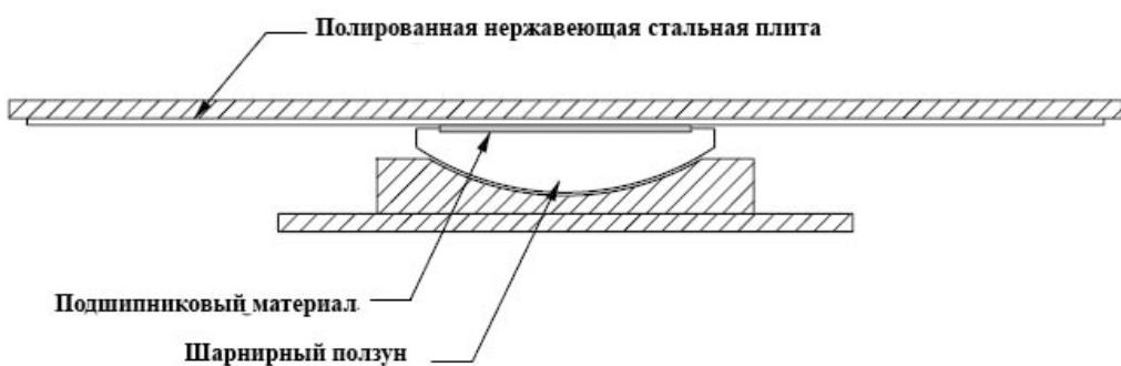
Рис.1. Устройство плоского маятникового подшипника - сейсмоизолатора
